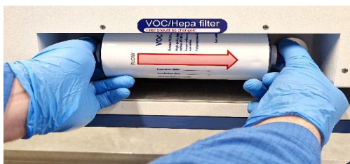
Slika 12.2 Postopek vstavljanja in odstranjevanja filtra VOC/HEPA
